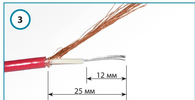
1.5. Для всех нагревательных матов, кроме МН-1420-9,5 и МН-1180-8,0 взять отрезок неизолированной медной жилы сечением 1 мм<sup>2</sup> длиной 85 мм и распустить на длине 12 мм с одного конца. Приложить ее распущенной частью к нагревательной жиле, придерживая скрученную часть вместе с изоляцией (рис. 4). Нагревательную и вспомогательную неизолированную медную жилу скрутить вместе и затем отрезать до размера 7 мм.
