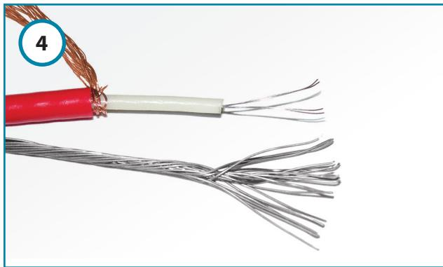
Для нагревательных матов МН-1420-9,5 и МН-1180-8,0 операция присоединения вспомогательной медной жилы исключается. Жилы в этих секциях сразу подрезаются до длины 7 мм.
