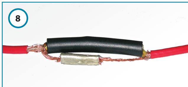
1.9. На соединение продвинуть термоусаживаемую трубку 80 мм и усадить феном при температуре 350 °C до появления kleевой массы по краям трубы (рис. 9).
