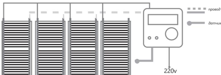
рис.4 (схема подключения)
