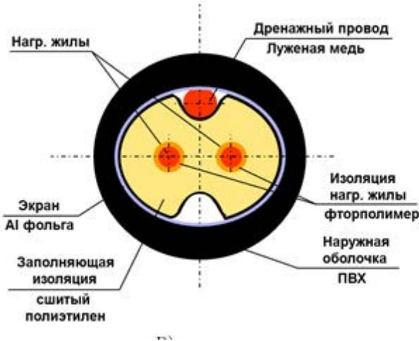
Рис. 2. Устройство нагревательного кабеля ДЕВИ Snow-30Т
