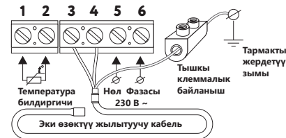
2-сүр. Матты электр тармагына туташтыруу схемасы
