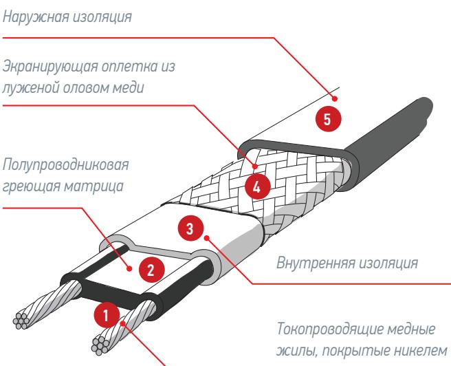
1. BUS WIRE NICKEL PLATED COPPER WIRE (токопроводящие медные жилы, покрытые никелем)
