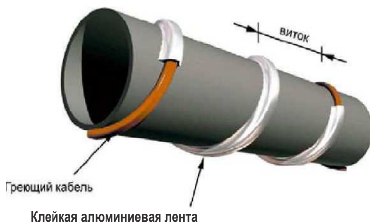
Рис.6 Монтаж кабеля по спирали
