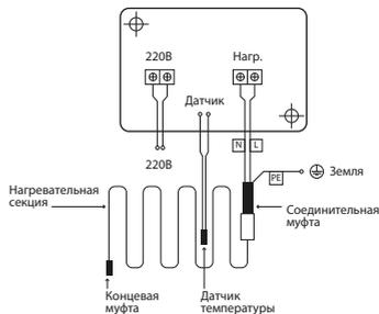
Рис.1 Терморегулятор HLT-104
