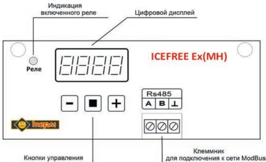
Для отображения информации и управления в приборе имеется четырехразрядный цифровой индикатор, светодиод включения реле и три кнопки.
