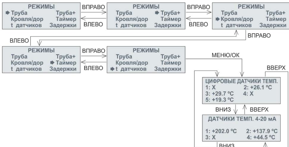
Рисунок 24. Активация режима «t датчиков»
