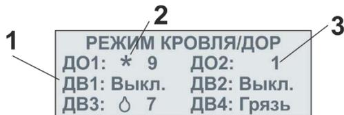
Рисунок 18. 4-е окно рабочего режима «Кровля дор»
