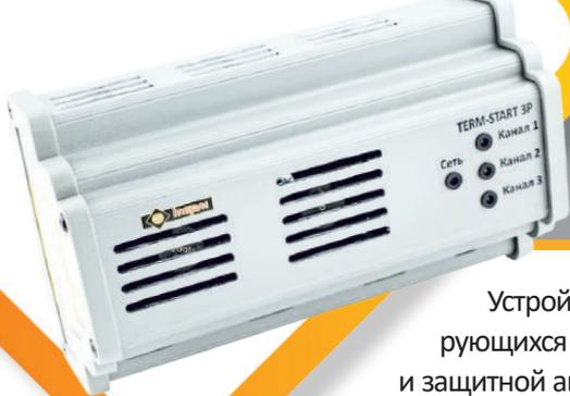
Устройство плавного пуска TERM-START 3P предназначено для коммутации саморегулирующихся нагревательных кабелей без необходимости использования мощных пускателей и защитной автоматики избыточной мощности за счёт ограничения пусковых токов на уровне номинального. Имеет 3 независимых канала коммутации – возможно подключать каждый канал на отдельную фазу А, В или С.
