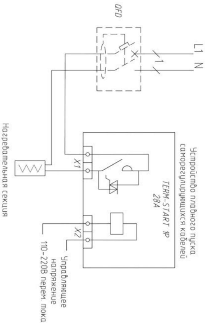
**ПРИМЕЧАНИЕ** сечение проводов, подходящих к разъему X1 должно быть рассчитано на номинальный ток нагрузки.
