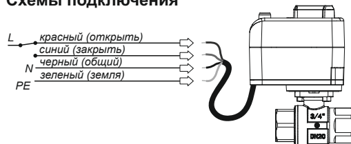
Электрическая схема подключения крана с электроприводом серии Neptun Bugatti Click 230В (рис. 3)
